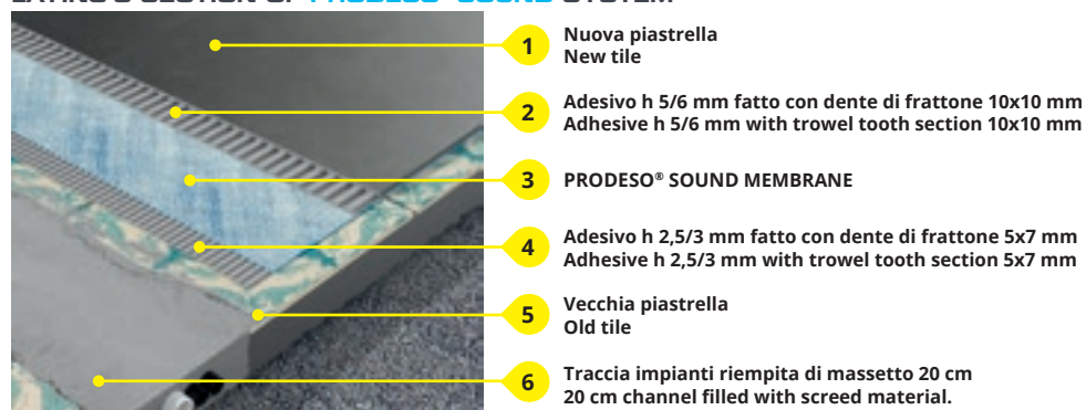
SEZIONE DI POSA DI PRODESO® SOUND SYSTEM LAYING'S SECTION OF PRODESO® SOUND SYSTEM
