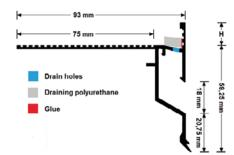
粉末塗層鋁的收邊條。它旨在保護鋪在瓷磚上的邊緣露台和陽台,以確保適當的排水。由保證其正確定位的墊 片和防止矽樹脂阻塞排水孔的開孔聚氨酯膠粘帶提供。
